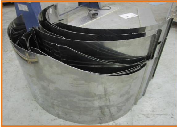
Раскройка металла и изготовление теплообменника
