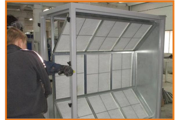
Изготовление силового каркаса будущей установки
